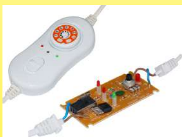
2019 Boîtier de commande de couvertures chauffantes à réglage de puissance électronique continu (Collection Ultimheat)
