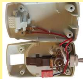
1995 : Commande américaine de couverture chauffante à doseur d'énergie semblable à celle développée plus de 50 ans auparavant par Cook en 1942. Vue extérieure et vue du bilame interne à rupture lente avec résistance anticipatrice. Seule évolution notable, ce modèle comporte un filtre antiparasite (Collection Ultimheat)
