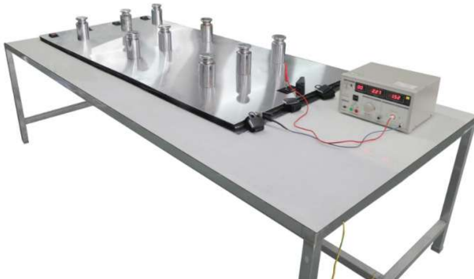
Equipement de mesure du courant de fuite total à froid
