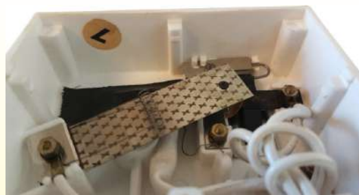
1970 ca réglage de puissance GEC (General Electric Company, Angleterre) sur couverture chauffante anglaise. La résistance anticipatrice est clairement visible au-dessus du bimétal et du contact à rupture lente (Collection Ultimheat).
