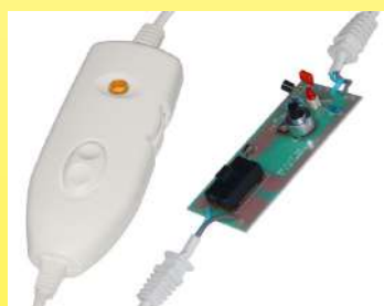
2019 Boîtier de commande de couvertures chauffantes à réglage de puissance électronique continu (Collection Ultimheat)
